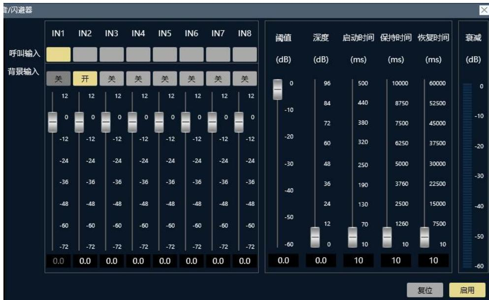
将输入通道 IN1 作为呼叫输入，输入通道 IN2 作为背景输入，通过闪避器处理，在输出通道 OUT1 中输出，配置如上图：
