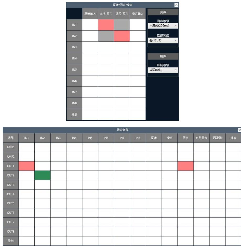
本地输入信号为 IN1 通道，远程输入信号为 IN2 通道，本地输入信号通过 OUT1 通道输出至远程，远程输入信号通过 OUT2 通道输出至本地扩声，配置如上图所示：
