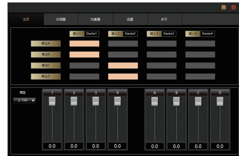
整个系统设备连接可轻松通过软件进行实时切换, 设备状态一目了然, 单播, 多播, 时钟同步轻松设定
